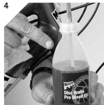
4. Sicherstellen, dass das Ende des Entlüftungsschlauchs während aller Arbeiten IMMER im Ölbad liegt. Make sure that the end of bleeding tube is always in the oil bath during the following procedure. Assurez-vous que le tube de purge se trouve toujours immergé dans l'huile pendant tous les travaux qui suivront.
