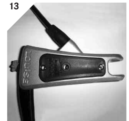
13. Ausgleichsbehälterdeckel abnehmen und den vom Kit auf den Griff legen. Dismount reservoir cover and put the one delivered with the pro bleed kit on the master. Démontez le couvercle du réservoir et poser celui livré avec le kit sur le bocal.
