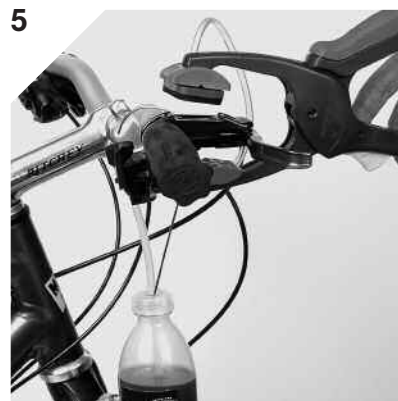
5. Zange nach Öffnen des Ausgleichsbehälters und Entnahme der Membran korrekt positionieren und fixieren. After removal of reservoir cover and membrane place bleed clamp correctly and fix it properly. Après démontage du couvercle du réservoir et la membrane, positionner la pince et veiller à une bonne fixation.
