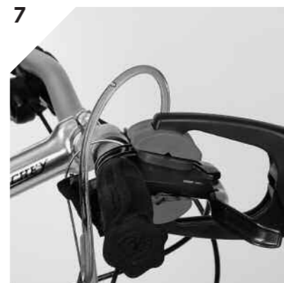
7. Öl mit Spritze durch System drücken. Luftblasen sieht man im transparenten Schlauch. Press oil through the circuit. Air bubbles can be seen in transparent tube. Presser l'huile à travers le circuit. Des bulles d'air sont visibles dans le tube transparent.
