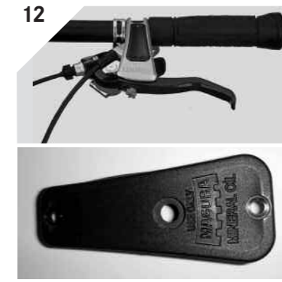
12. Für die Louise des Modelljahres 2007 benötigt man den zusätzlichen Adapter für eine korrekte Befüllung! To fill a Louise of model year 2007 properly you need the additional adaptor that comes with the kit. Pour remplir un Louise du millésime 2007 on doit utiliser l'adaptateur qui est livré avec le kit. Membran und Deckel aufsetzen und Arbeiten wie im Workshop Manual beschrieben beenden. Nach erfolgter Entlüftung immer Funktionsprobe durchführen!
