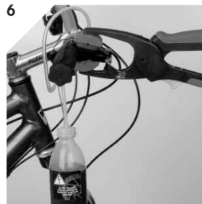
6. Korrekt montierte Entlüftungs-Zange. Diese muss den Ausgleichsbehälter hermetisch abdichten! Correctly installed bleed clamp. The reservoir has to be hermetically sealed! Pince de purge correctement montée. Le réservoir doit être hermétiquement fermé et étanche.
