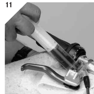
11. Ausgleichsbehälter muss RANDVOLL sein, ggf. mit Spritze nachfüllen. The reservoir has to be full to the top, add if necessary oil with the syringe. Le bocal doit être plein à ras de bord. Ajouter le cas échéant de l'huile avec la seringue.
