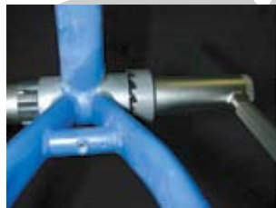
1. Tarauder et dresser le boîtier de pédalier - recommandé. Cette opération doit être exécutée par un professionnel.
