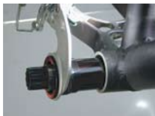
4c. E-type derailleur: Slide your derailleur over the spindle assembly.
