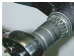
5. Vissez l'axe de pédalier en tournant dans le sens antihoraire et serrez la cuvette du côté entraînement en respectant un couple de serrage de 35 pi-lb.
