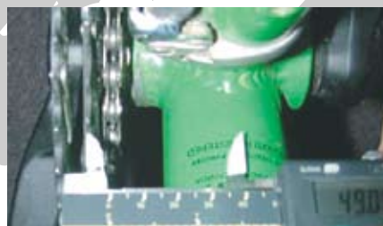
6. Serrez la cuvette du côté opposé à l'entraînement jusqu'à ce qu'elle arrive en butée. Vérifiez que le couple de serrage est de 35 pi-lb.
