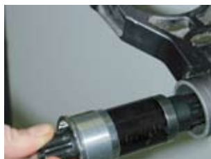
4 b). boîtier de 73 mm: Ne pas utiliser la rondelle entretoise.
