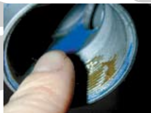
2. Appliquez une couche de graisse sur les filetages à l'intérieur du boîtier de pédalier pour éviter le grippage ou l'usure.
