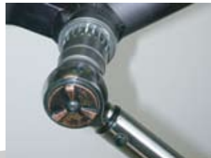
6. Serrez la cuvette du côté opposé à l'entraînement jusqu'à ce qu'elle arrive en butée. Vérifiez que le couple de serrage est de 35 pi-lb.
