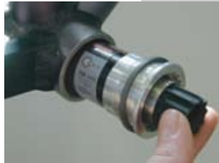
4 a). boîtier de 68 mm: Glissez la rondelle entretoise de 2,5 mm fournie sur l'axe pour l'amener en contact contre le rebord de la cuvette du côté entraînement.
