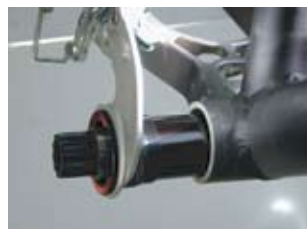
4 c). dérailleur de type E: Glissez le dérailleur par dessus l'axe.
