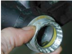
3. Vissez la cuvette du côté opposé à l'entraînement de trois à quatre tours à la main.
