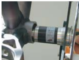
4 d). guide de chaîne: Glissez le guide de chaîne et toutes les rondelles entretoises nécessaires (voir Réglages de la ligne de chaîne ci-dessous) par-dessus l'axe.
