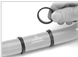
Bild 1: Centerring Demontage Wenn diese Lenker in einem „konventionellen“ Vorbau verwendet werden, müssen die beiden aufgesprengten Kunststoff Zentrierringe in der Lenkermitte abgestreift werden. Legen Sie einen Lappen um die Ringe, dann den Lappen greifen und den Lenker kräftig gegen den Boden drücken. Gegen Kratzer evtl. ein Handtuch o.ä. zwischen Lenker und Boden legen.
